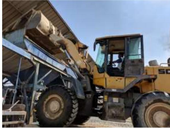
**Gambar 3** pengisian material menggunakan truck loader kedalam coltbin
