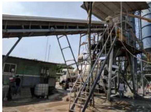
**gambar 4** material dari coltbin menuju mesin wet mix untuk diaduk
