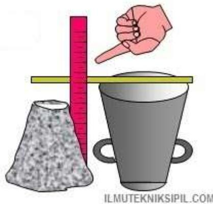
**Gambar 7** cara mengukur slump beton
